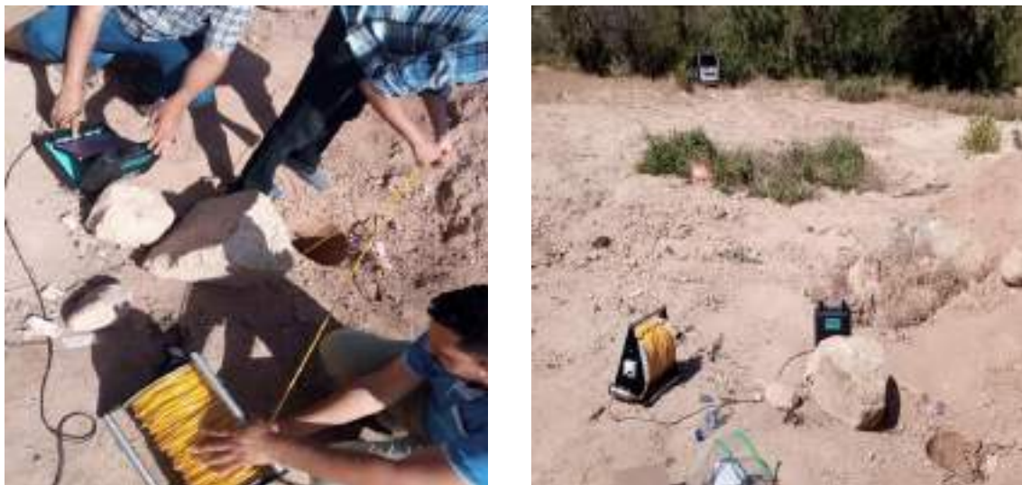
Figure 35 : Essai de la caméra d'inspection des forages
