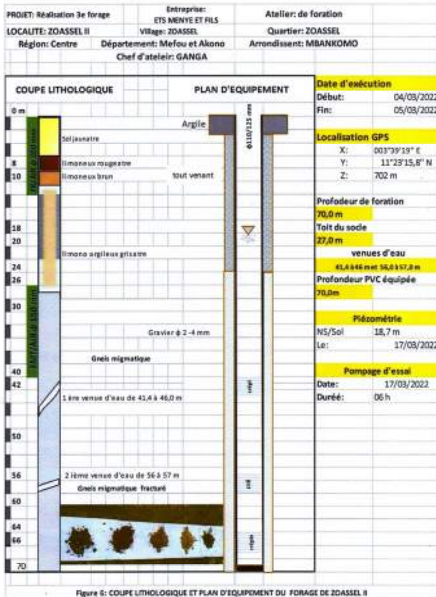
Coupe lithologique et plan d'équipement du forage de ZOUASSEL II © Source : Rapport technique Ets Menye & Fils
