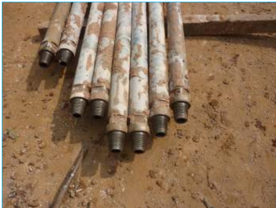
Tiges en acier de 4,70m utilisées pour les travaux de foration
