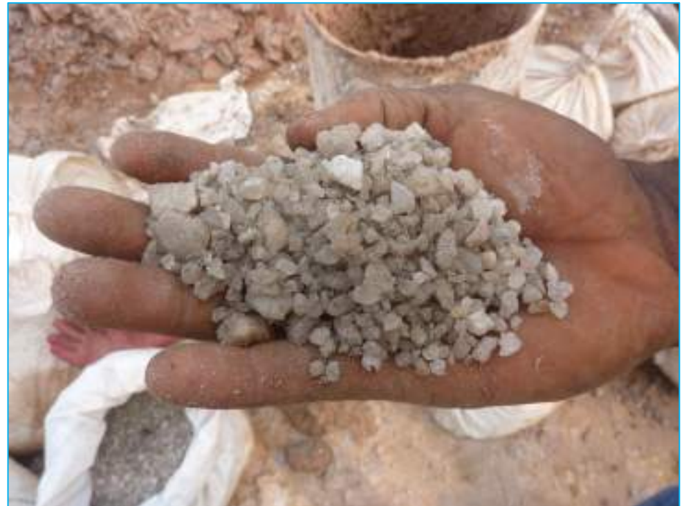
Massif filtrant enfoui dans l'espace annulaire (ici, 25 sacs de 50 kgs de massif filtrant ont été enfouis dans l'espace annulaire du forage)
