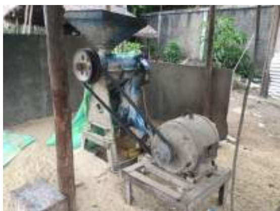
Figure 25 : Décortiqueuse électrique se substituant au traditionnel pilon
