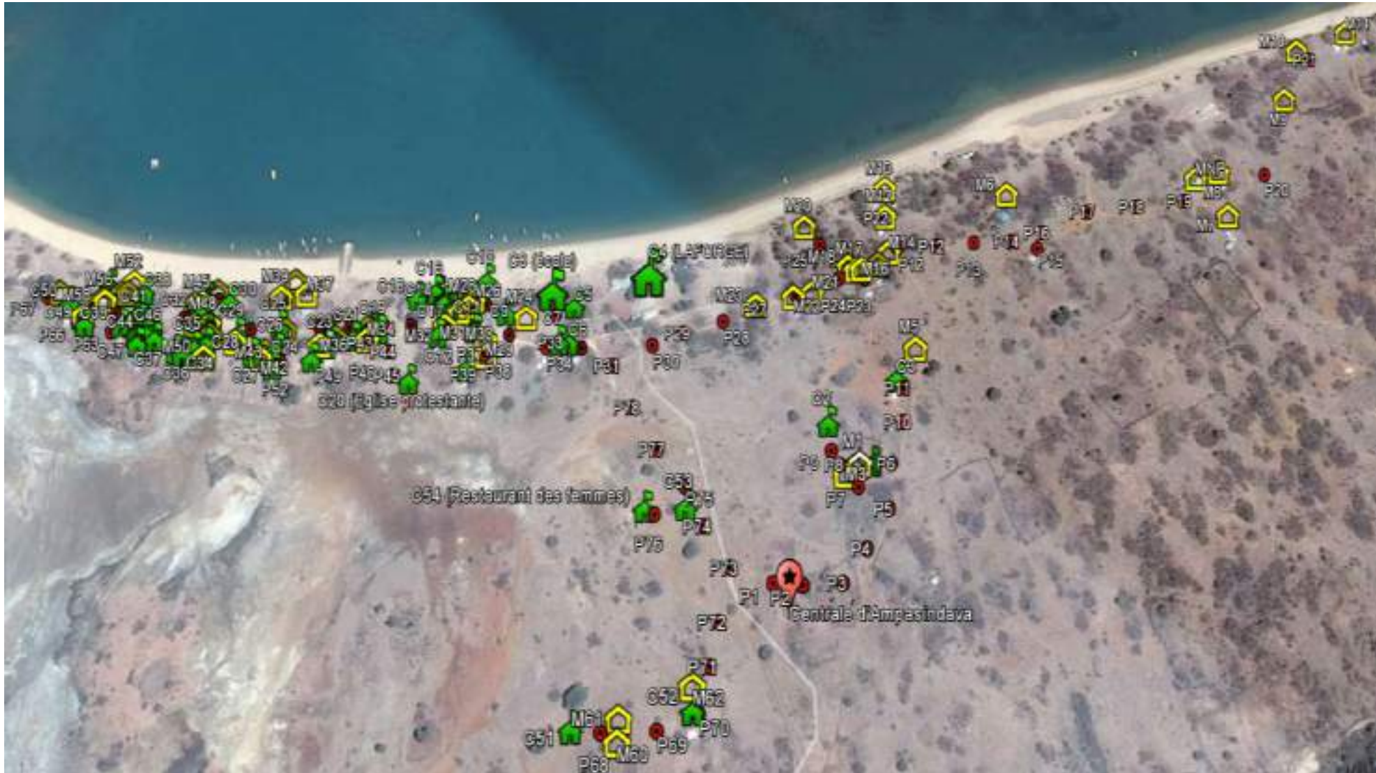
Figure 3 : Aperçu du réseau. En vert figurent les foyers clients, en jaune les foyers n'étant pas encore raccordés, et en rouge sont repérés les poteaux électriques
