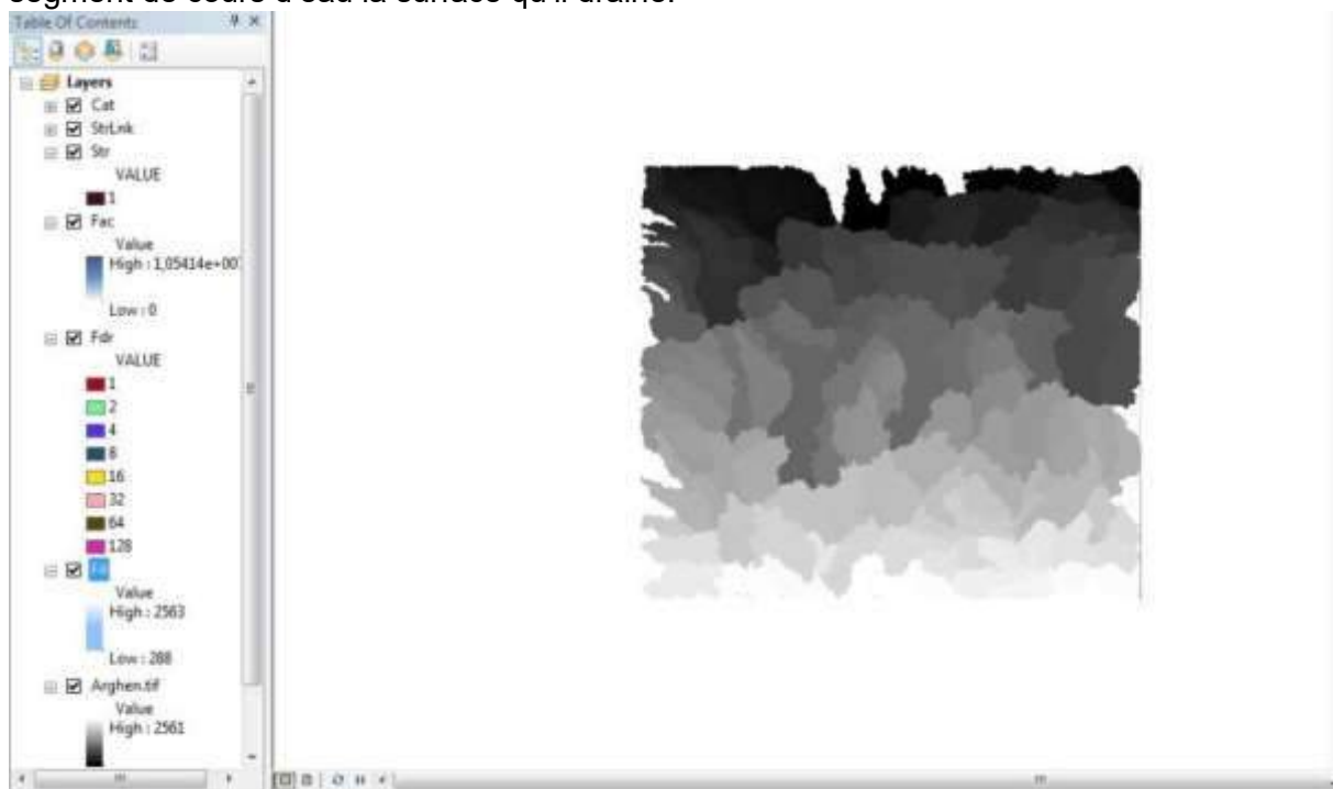
Figure 11: Résultat de la commande Catchment Grid delineation
