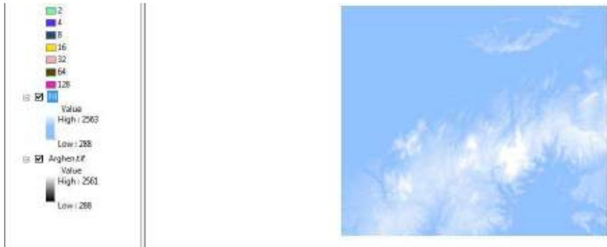
Figure 7: Résultat de la commande Fill Sinks
