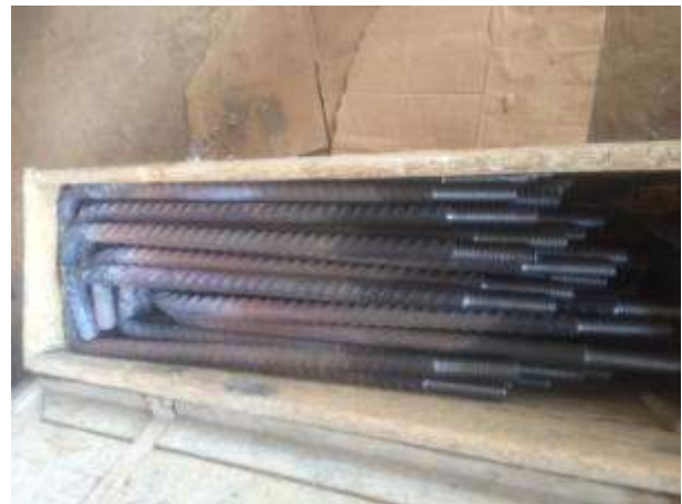
Figure 5 : crosses de fixation des poteaux
