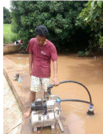
Figure 35 : Pompe d'épreuve 3 bar
