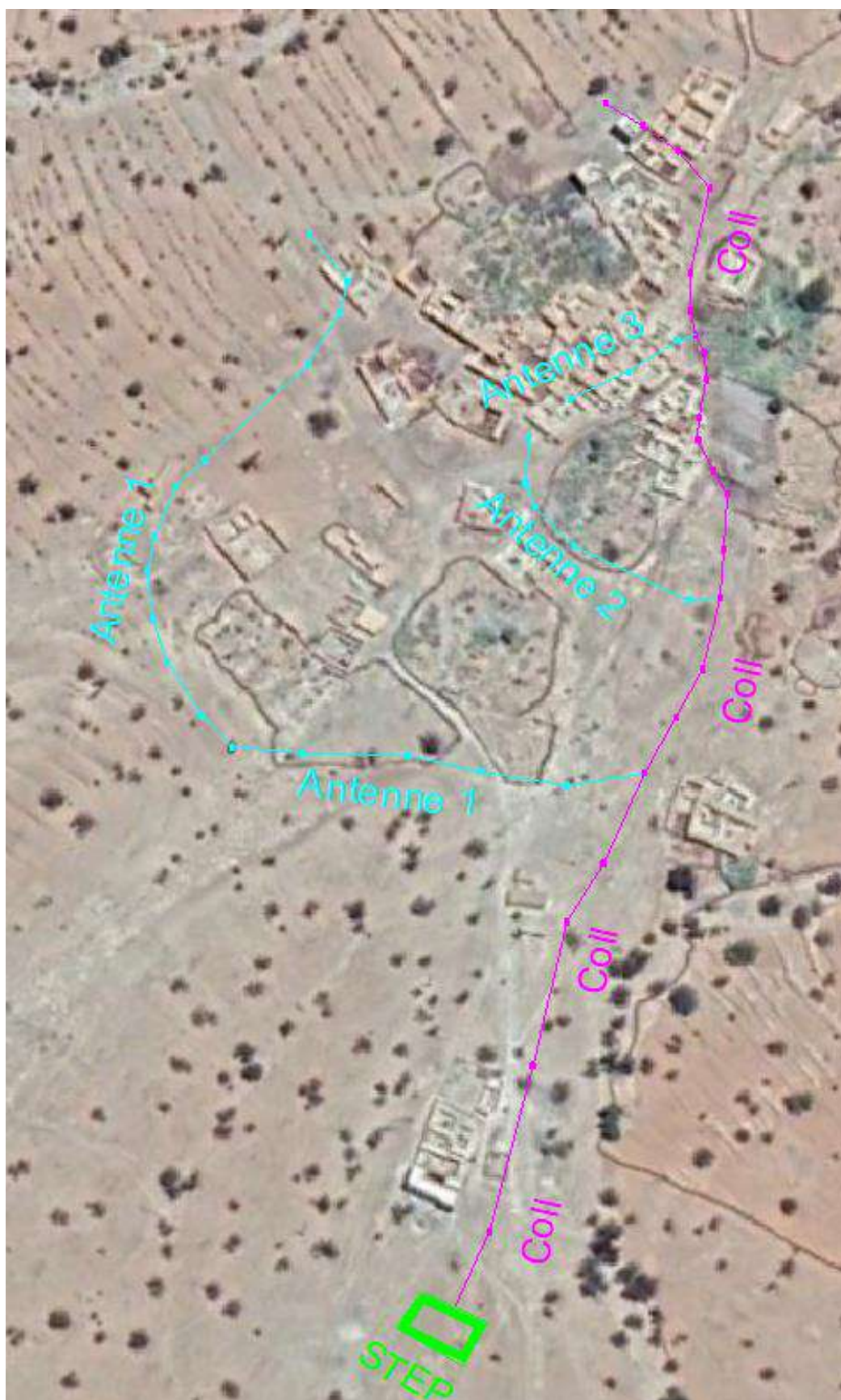
Tracé du réseau de collecte de Taguant
