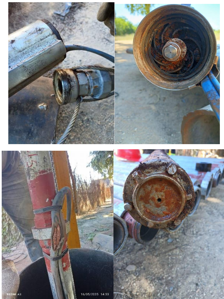
Figure VI-2 : Dégât de la pompe et le câblage électrique
