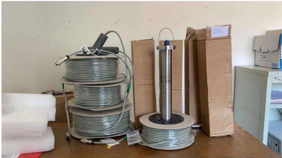
**Figure 15 : Sonde piézométrique**
