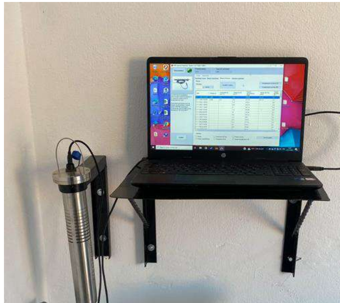
Figure 4 Sonde piézométrique d'Ait Hsayn
