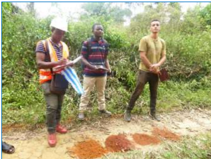
Prélèvement des cuttings par les parties au contrôle des travaux. De gauche à droite : M. Ondo Germain (Ingénieur des Ets Menye & Fils) ; M. Djoufack Baudos (Ingénieur d'ERA-Cameroun) ; et M. Johannes MOGES (Stagiaire Experts-Solidaires)
