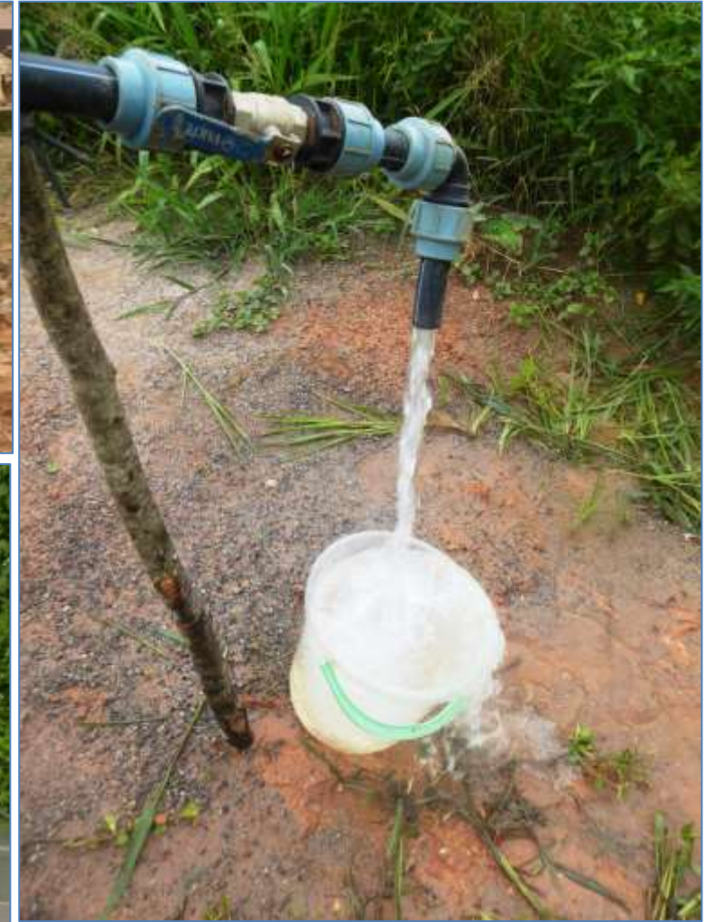
Quelques clichés pris lors des essais de pompage jusqu'à obtention d'une eau claire à Angon (Aboa), Zouassel, Nkong-Ondoa et Mbankomo-Centre sur la supervision des parties au contrôle © Projet MODEAME-Mbankomo
