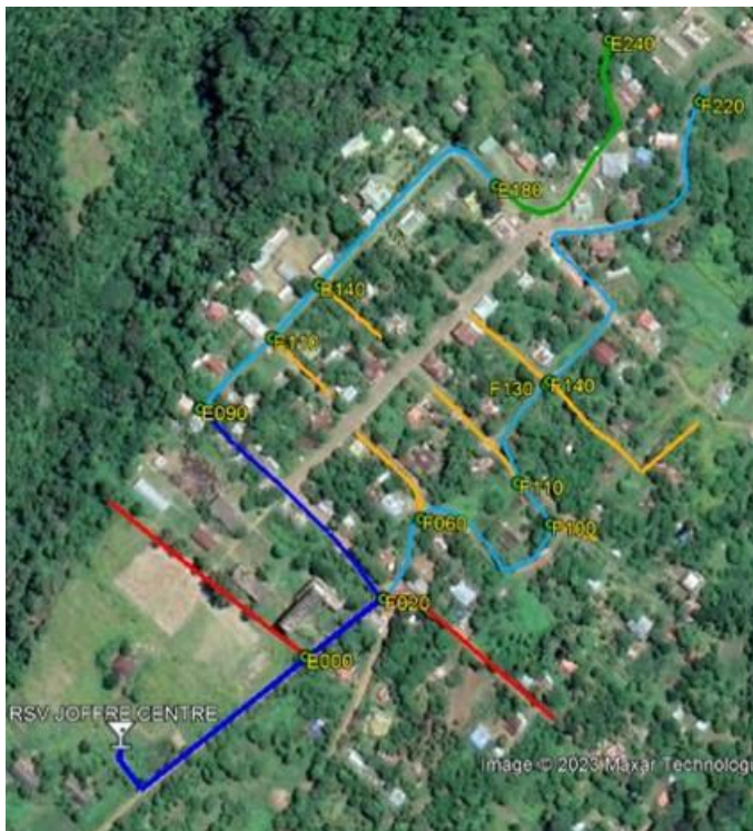
Figure 21 : Image extraite du diagnostic réalisé par l'entreprise. Cette image représente la distribution actuelle de Joffre-ville centre. Le code couleur permet de savoir quelles conduites sont à remplacer, lesquelles sont à conserver et quels sont les extensions prévues.
