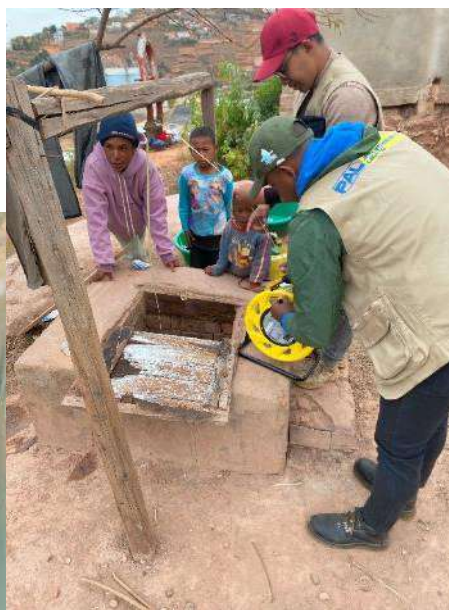
Photos des mesures de la profondeur des nappes phréatiques réalisées avec un piézomètre et par le biais des puits
