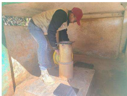
Photos des mesures de la profondeur des nappes phréatiques réalisées avec un piézomètre et par le biais des puits
