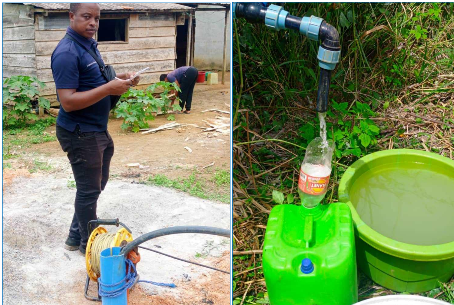
L'ingénieur hydraulicien de l'entreprise adjudicataire durant les opérations des essais de pompage à NTOUMBA © AUNTD 2025
